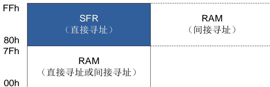
内部 256 bytes RAM 结构图
