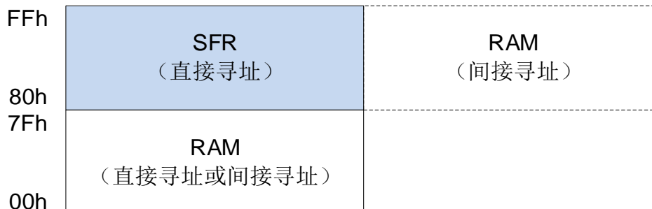
内部 256 bytes RAM 结构图
