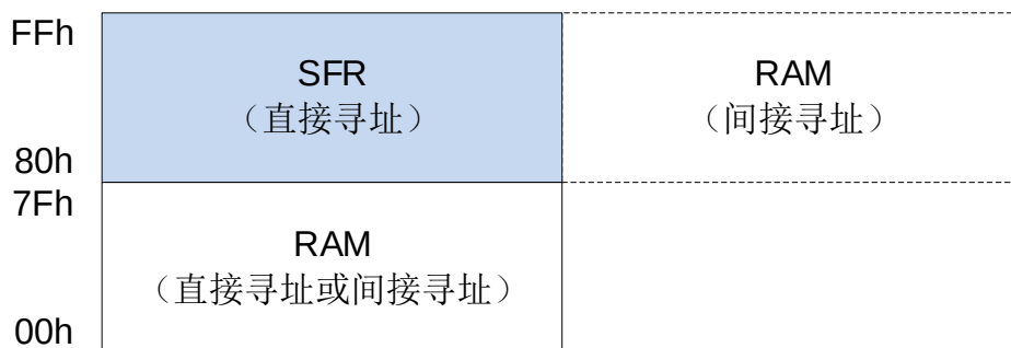
内部 256 bytes RAM 结构图
