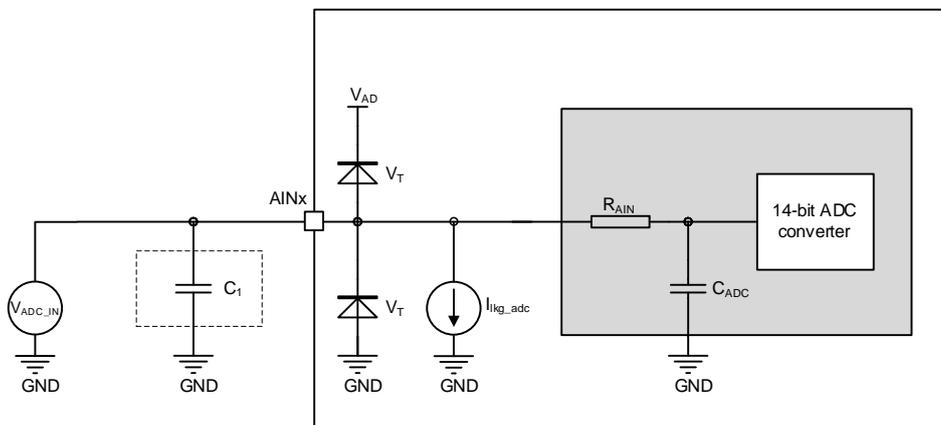
说明：用户如需进一步提高 ADC 性能，建议在 AINx 通道外接 C1 电容，容值为 0.01uF。
