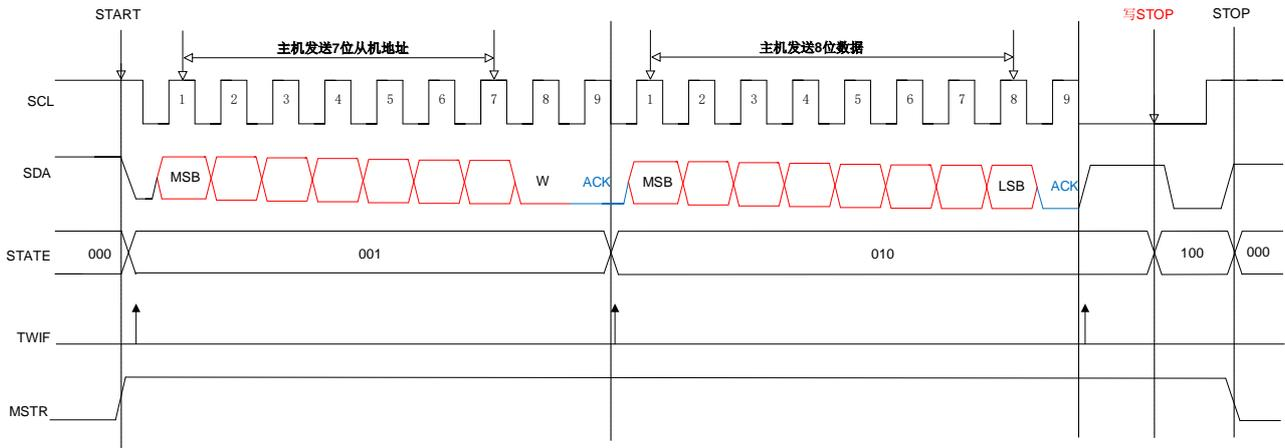
如果从机应答高电平，表示当前字节传输完以后，从机会主动结束本次传输，不再接收主机发送的数据，主机 STATE[2:0]从发送数据状态 010 切换为 100:
