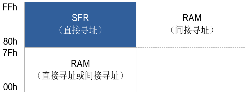
内部 256 bytes RAM 结构图
