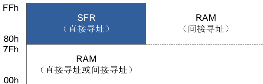
内部 256 bytes RAM 结构图
