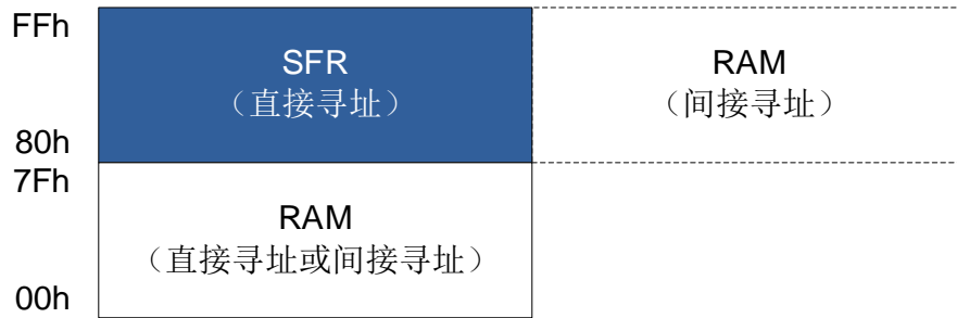
内部 256 bytes RAM 结构图
