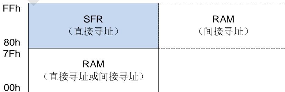
内部 256 bytes RAM 结构图
