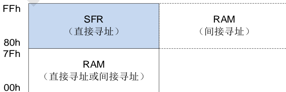
内部 256 bytes RAM 结构图
