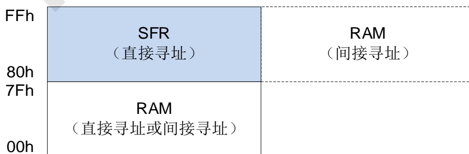
内部 256 bytes RAM 结构图
