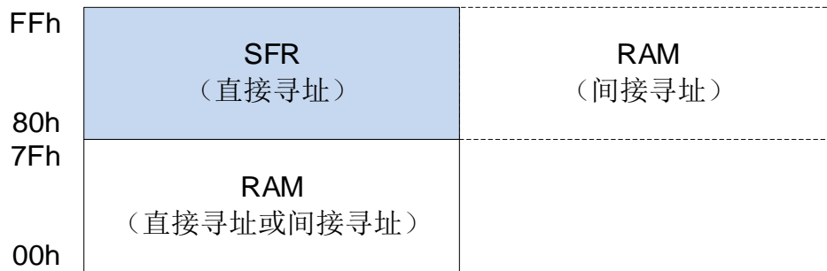
内部 256 bytes RAM 结构图
